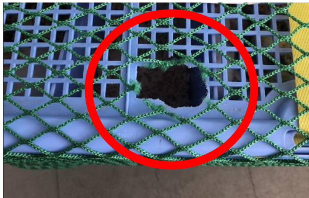
※カラージャービルにより食い破られたプラスチック製ケース（赤枠部）
